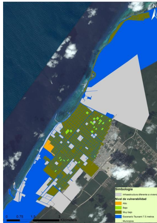
Figura 91. Vulnerabilidad física de la vivienda ante un tsunami de 7.5 m en la ciudad de Cozumel.
