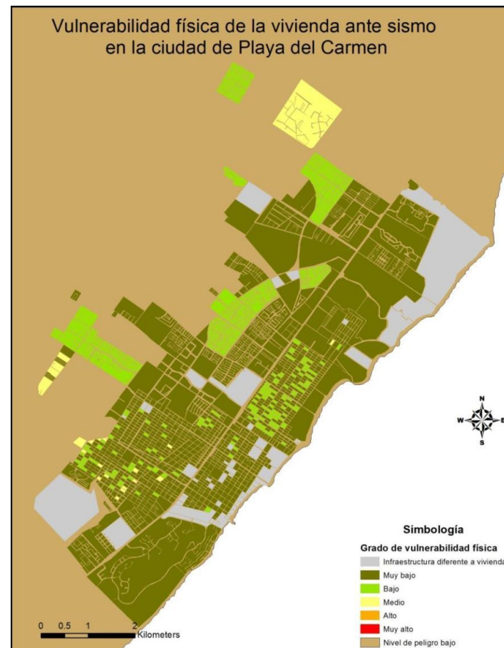
Figura 63. Vulnerabilidad física de la vivienda ante sismo en la ciudad de Playa del Carmen. Tulum
