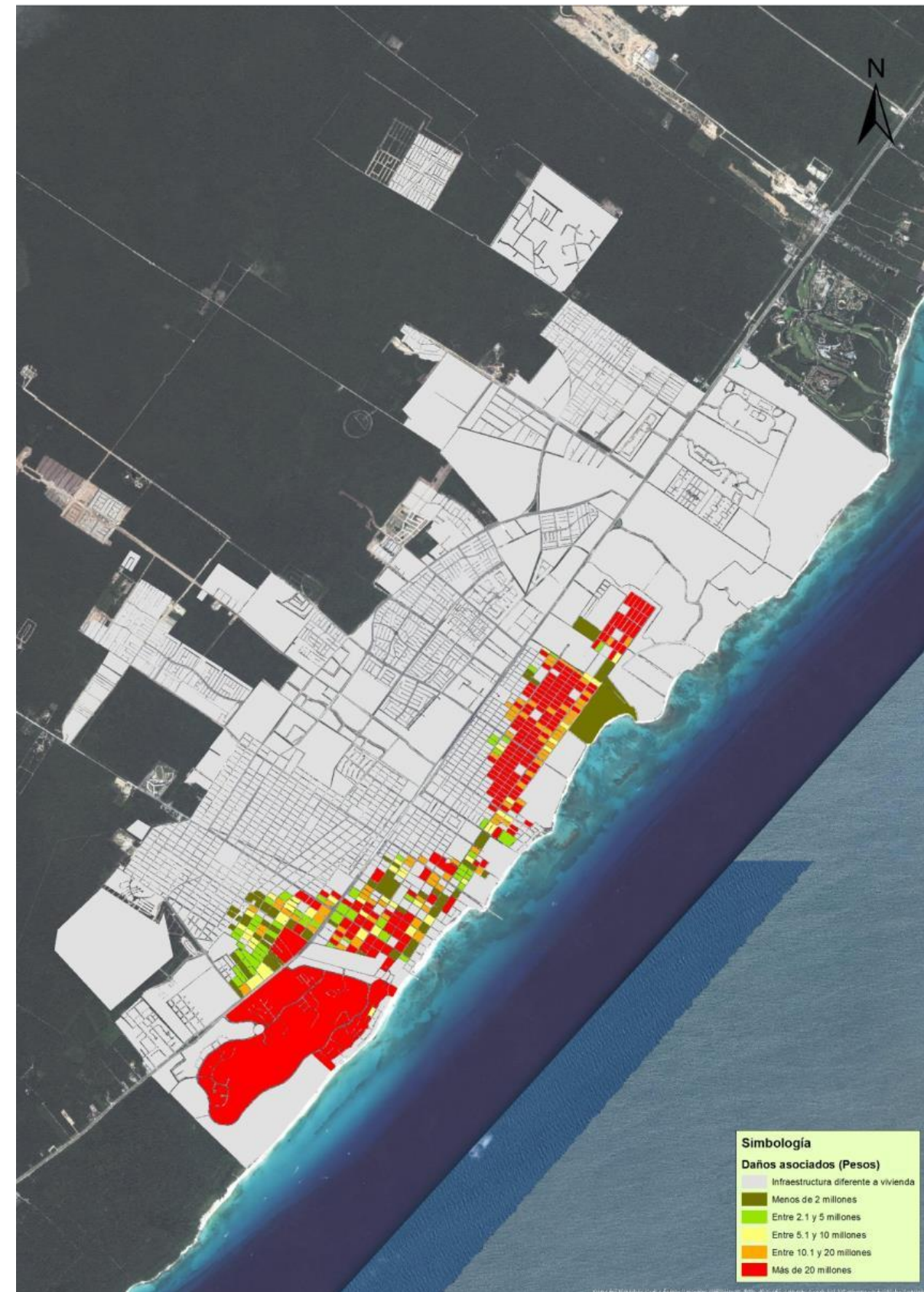
Mapa 86. Daños asociados por el efecto de marea de tormenta provocada por un huracán categoría III.
