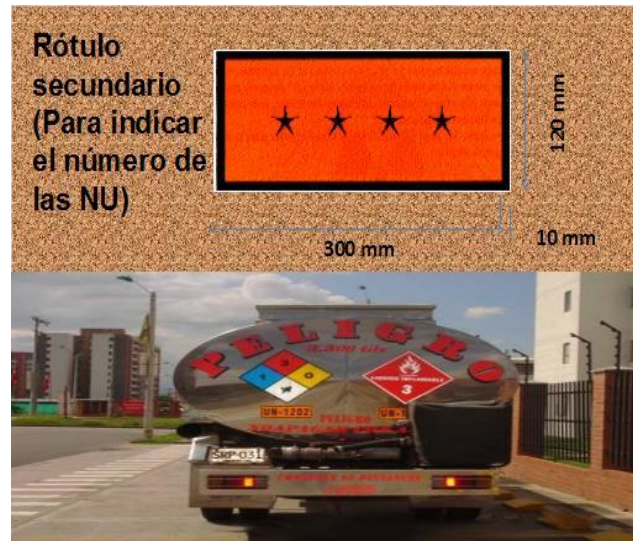
Fotografía 15. Rombo el cual tiene la pictografía del peligro del material transportado.
